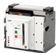
Switch-Disconnecter · DC : up to 100 kA/1 s, 4,000 A
