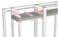
Instalación soporte en profundidad, embarrado horizontal
