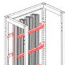
Instalación soporte en fondo, embarrado vertical
