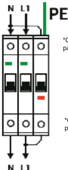
\*Conectar neutro (N) en la parte superior de la bobina
